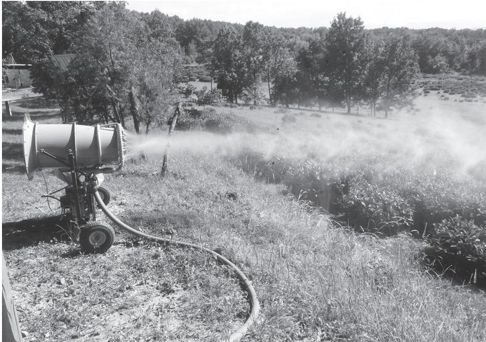
Рис. 1. Снегогенератор (снежная пушка) ESG-305 в работе
